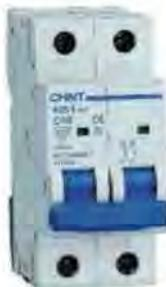
termici NB1-63 è accessoriabile con: contatti di segnalazione dello stato on/off in scambio, contatti di allarme in scambio, bobine a lancio di corrente per uno sgancio da remoto dell'interruttore e bobine di minima tensione per l'apertura dei contatti in caso di eccessive variazioni di tensione. Se l'utente finale desidera una protezione differenziale, è possibile abbinare un blocco differenziale accoppiabile per tutte le polarità e tipologie di protezione.
