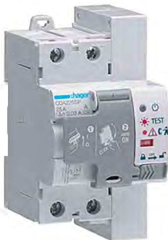
Gli interruttori differenziali puri tipo SRD hanno la capacità di coniugare la continuità di servizio con la sicurezza della casa riarmandosi rapidamente per ripristinare l'alimentazione elettrica in caso di scatti improvvisi. L'azione avviene non prima di aver constatato che non vi siano criticità nel circuito a valle.
