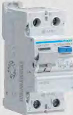
F Hager si integrano perfettamente, sia dal punto di vista estetico sia da quello prestazionale, con tutti gli altri interruttori della gamma Hager. Dotati di morsetti IP2X, terminali bi-connect per cavi o barrette di cablaggio, indicazione di posizione aperto-chiuso e di intervento differenziale, doppia clip di fissaggio alla guida DIN, portacartellino integrato.
