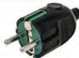
hanno tutte gli spinoli in ottone nichelato protetti da contatti accidentali tramite isolamento, le prese sono dotate di alveoli protetti da contatto accidentale, mentre spine e presa, sono dotate di passacavo di protezione in materiale
