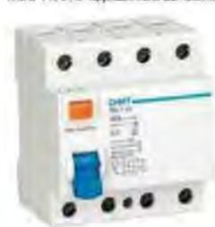
Conserva le caratteristiche di intervento anche in presenza di corrente continua sovrapposta del valore massimo di 10 mA. È immune da fenomeni transienti, grazie a ritardo intenzionale d'intervento di 10 ms. Ed è immune da disturbi determinati da sovratensioni di origine atmosferica in quanto testati fino a 3 kA con un impulso pari a R/20 μs.
